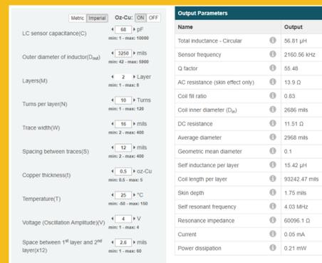
Figure 3: TI WEBENCH® Coil Designer Parameters
